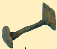
Det er umulig å tenke seg vikingtiden uten jernnagler til skipsskrogene. Foto Mekonnen Wolday
